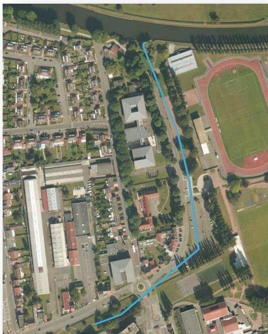
Il s'agit d'un **chantier exceptionnel** qui **nécessite notamment l'utilisation d'un microtunnelier** qui permet d'installer des tuyaux de 2 mètres de diamètre à une profondeur de 10 mètres environ, sans tranchée.
